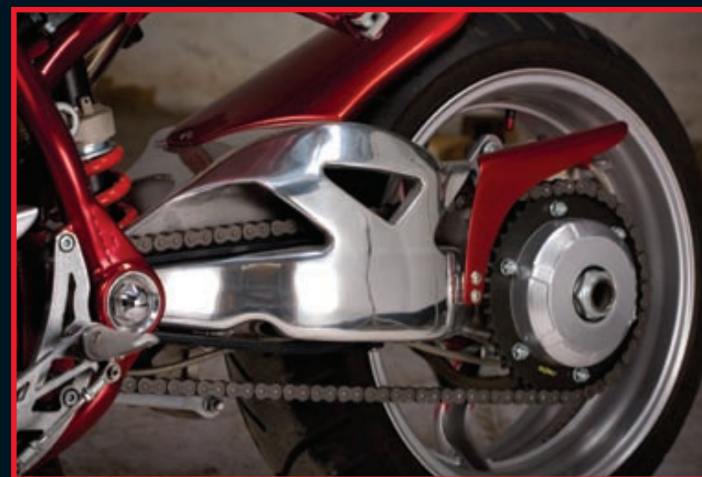
YAMAHA V-MAX 1200 | LETMO ULOŽENÉ ZADNÍ KOLO | VYROBENÉ HLINÍKOVÉ „BRÝLE“ DO PŘEDNÍ VIDLICE | AIRBRUSH CELÉ MOTORCYKLE VČETNĚ MOTORU | PŮVODNÍ POUZE MOTOR A ČÁST RÁMU YAMAHA V-MAX 1200 | ONE-SIDED FITTING OF THE REAR WHEEL | DOUBLE HOLDER OF THE FRONT FORK | AIRBRUSH OF THE WHOLE MOTORBIKE & THE ENGINE | FROM ORIGINAL ONLY THE ENGINE AND PART OF THE FRAME
