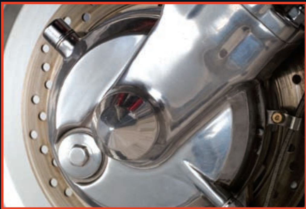
HONDA VALKYRIE | PRAVOSTRANNÝ KARDAN | 2X VODNÍ CHLADIČ ŘEŠENÝ V PŘEDNÍCH TUBUSECH | HLINÍKOVÁ KYVNÁ VIDLICE VYROBENÁ Z JEDNOHO KUSU HLINÍKU | MOTOR LADĚNÝ NA SPODEK HONDA VALKYRIE | RIGHT-HAND CARDAN SHAFT | 2X WATER COOLER INTEGRATED IN FRONT TUBES | ALUMINIUM PIVOTING FORK MADE OF ONE PIECE OF ALUMINIUM | HIGH PERFORMANCE ENGINE MODIFICATION
