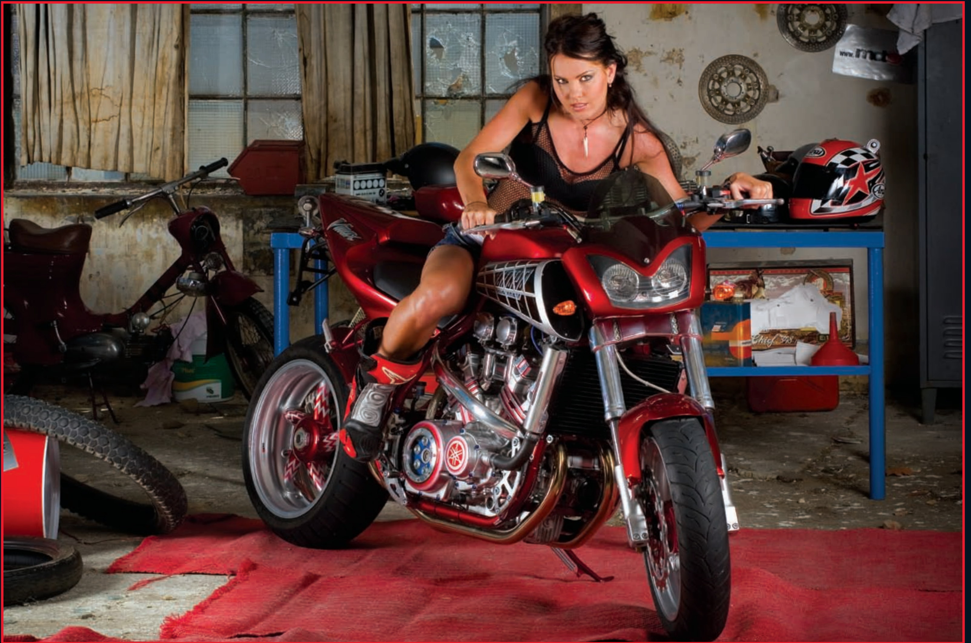
YAMAHA V-MAX 1200 | CELOHLINÍKOVÁ NÁDRŽ Z JEDNOHO KUSU | LETMO ULOŽENÉ ZADNÍ KOLO | ÚPRAVA MOTORU NA VYŠŠÍ VÝKON + KN FILTRY | PŘEDNÍ VIDLICE UPSIDE DOWN YAMAHA V-MAX 1200 | ONE-PIECE ALL-ALUMINIUM TANK | ONE-SIDED FITTING OF THE REAR WHEEL | ENGINE MODIFICATION FOR HIGHER PERFORMANCE + KN FILTERS | UPSIDE DOWN FRONT FORK
