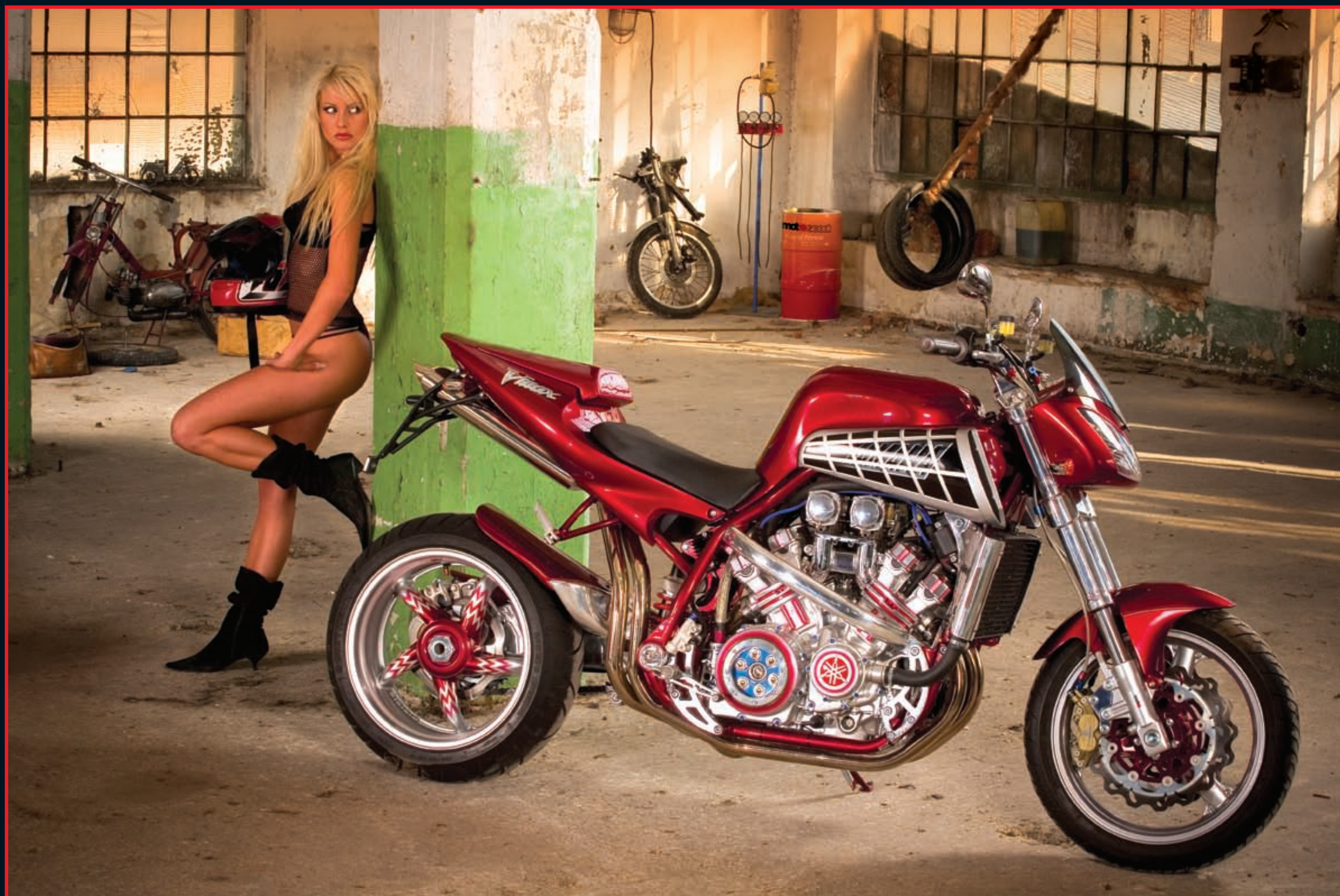
YAMAHA V-MAX 1200 | LETMO ULOŽENÉ ZADNÍ KOLO | VYROBENÉ HLINÍKOVÉ „BRÝLE“ DO PŘEDNÍ VIDLICE | AIRBRUSH CELÉ MOTORCYKLE VČETNĚ MOTORU | PŮVODNÍ POUZE MOTOR A ČÁST RÁMU YAMAHA V-MAX 1200 | ONE-SIDED FITTING OF THE REAR WHEEL | DOUBLE HOLDER OF THE FRONT FORK | AIRBRUSH OF THE WHOLE MOTORBIKE & THE ENGINE | FROM ORIGINAL ONLY THE ENGINE AND PART OF THE FRAME
