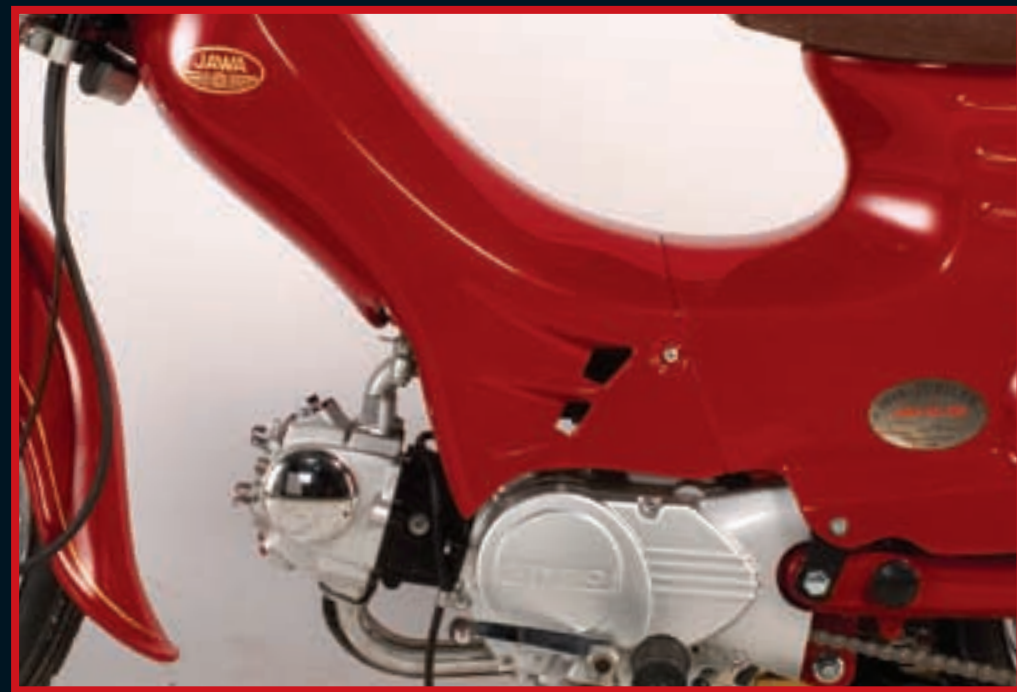
JAWA NEW PIONÝR 50 | ČTYŘTAKTNÍ MOTOR - VÝKON 3.6 PS, SPOTŘEBA 1,4L / 100 KM, HMOTNOST 76 KG | V NABÍDCE I 2-MÍSTNÁ VERZE | VYROBEN K 50. VÝROČÍ JAWY PIONÝR 555 (1956 - 2006) JAWA NEW PIONÝR 50 | 4-STROKE ENGINE OF 3.6 HP, FUEL CONSUMPTION 1.4 L / 100 KM, WEIGHT 76 KG | DOUBLE-SEAT VERSION | MADE TO THE 50 TH ANNIVERSARY OF JAWA PIONEER (1956-2006)
