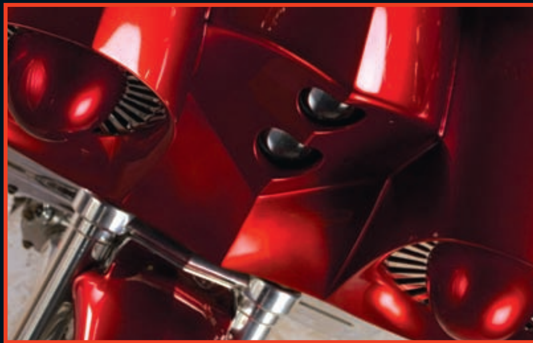
HONDA VALKYRIE | PRAVOSTRANNÝ KARDAN | 2X VODNÍ CHLADIČ ŘEŠENÝ V PŘEDNÍCH TUBUSECH | HLINÍKOVÁ KYVNÁ VIDLICE VYROBENÁ Z JEDNOHO KUSU HLINÍKU | MOTOR LADĚNÝ NA SPODEK HONDA VALKYRIE | RIGHT-HAND CARDAN SHAFT | 2X WATER COOLER INTEGRATED IN FRONT TUBES | ALUMINIUM PIVOTING FORK MADE OF ONE PIECE OF ALUMINIUM | HIGH PERFORMANCE ENGINE MODIFICATION
