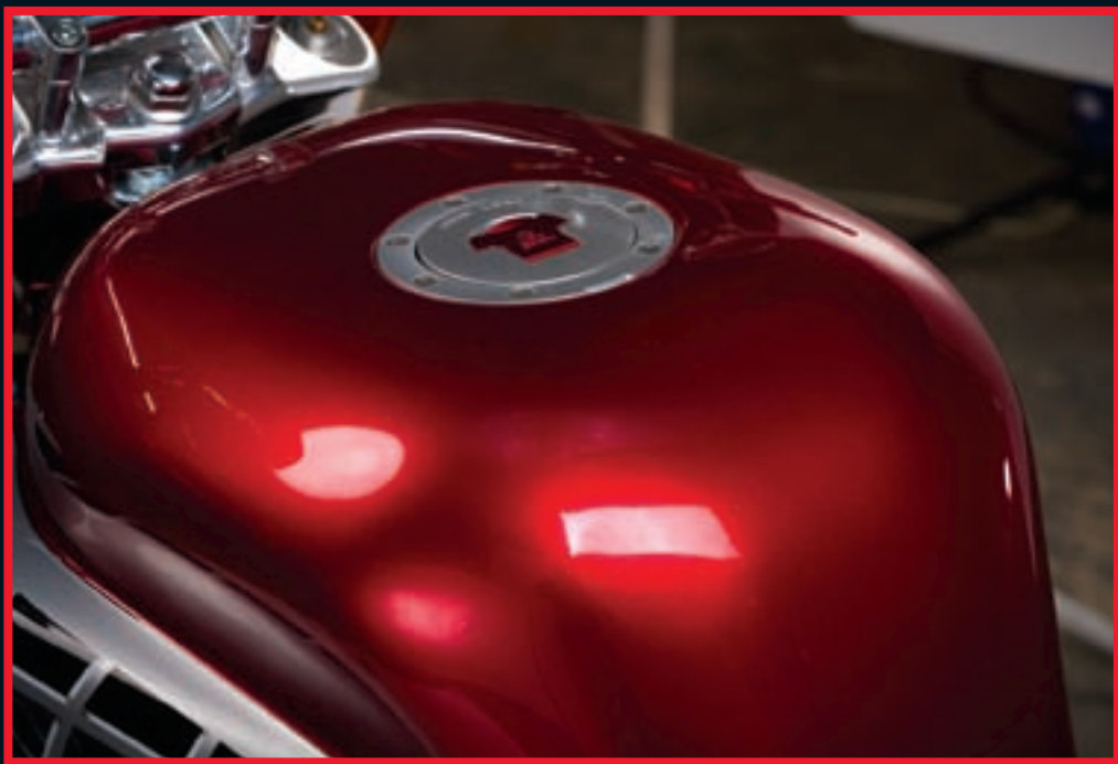
YAMAHA V-MAX 1200 | CELOHLINÍKOVÁ NÁDRŽ Z JEDNOHO KUSU | LETMO ULOŽENÉ ZADNÍ KOLO | ÚPRAVA MOTORU NA VYŠŠÍ VÝKON + KN FILTRY | PŘEDNÍ VIDLICE UPSIDE DOWN YAMAHA V-MAX 1200 | ONE-PIECE ALL-ALUMINIUM TANK | ONE-SIDED FITTING OF THE REAR WHEEL | ENGINE MODIFICATION FOR HIGHER PERFORMANCE + KN FILTERS | UPSIDE DOWN FRONT FORK
