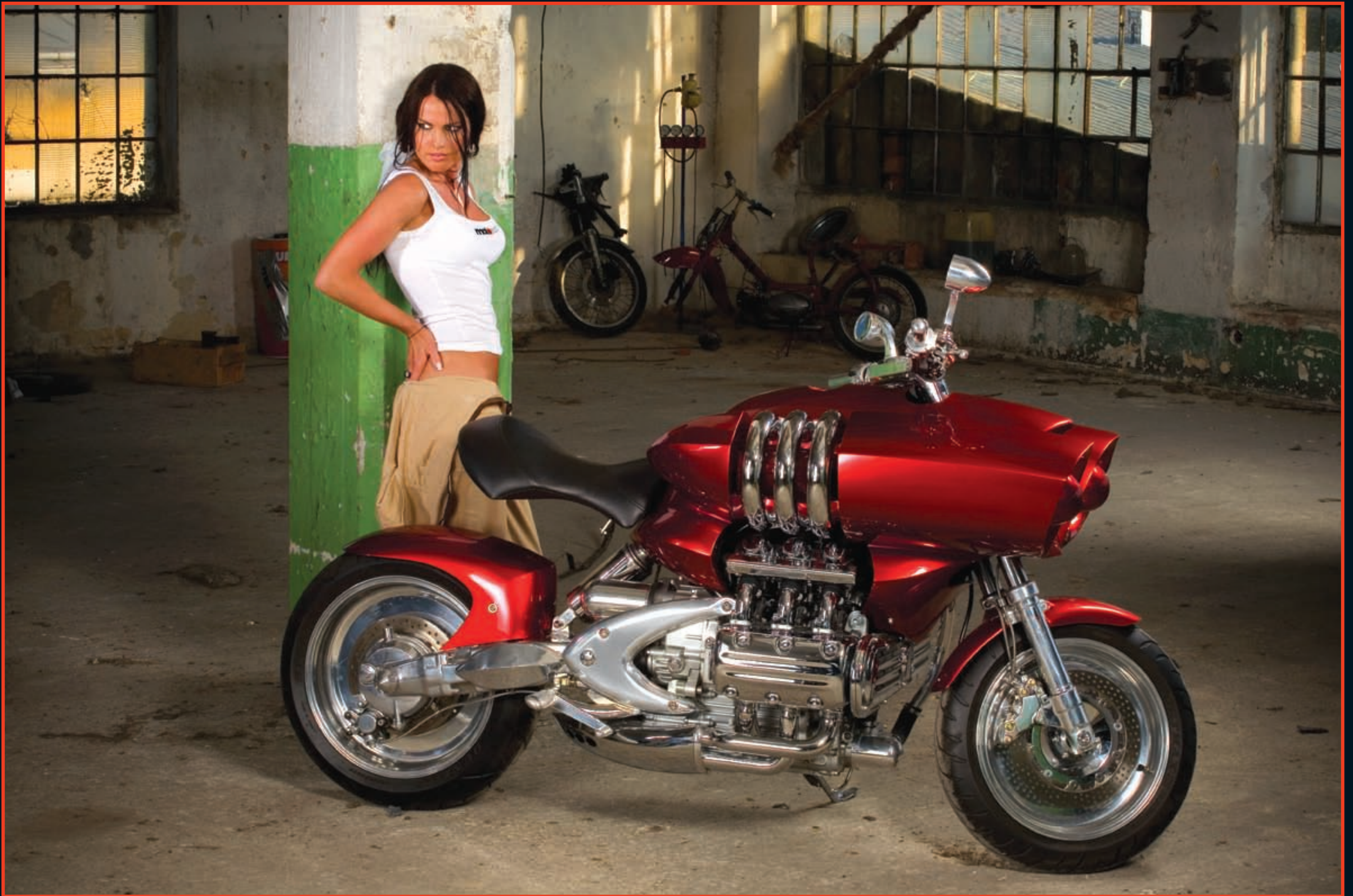
HONDA VALKYRIE | PRAVOSTRANNÝ KARDAN | 2X VODNÍ CHLADIČ ŘEŠENÝ V PŘEDNÍCH TUBUSECH | HLINÍKOVÁ KYVNÁ VIDLICE VYROBENÁ Z JEDNOHO KUSU HLINÍKU | MOTOR LADĚNÝ NA SPODEK HONDA VALKYRIE | RIGHT-HAND CARDAN SHAFT | 2X WATER COOLER INTEGRATED IN FRONT TUBES | ALUMINIUM PIVOTING FORK MADE OF ONE PIECE OF ALUMINIUM | HIGH PERFORMANCE ENGINE MODIFICATION
